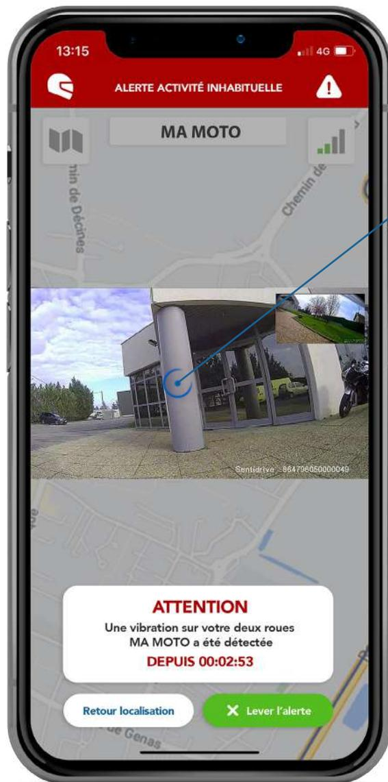
Affichage des vidéos du déclenchement de la vibration. La séquence vidéo dure 5 secondes et tourne en boucle.
