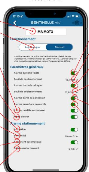
Activation / désactivation de l'envoi de la notification «batterie faible». Cette alarme est déclenchée lorsque la tension de votre véhicule est inférieure au seuil de déclenchement réglé.
