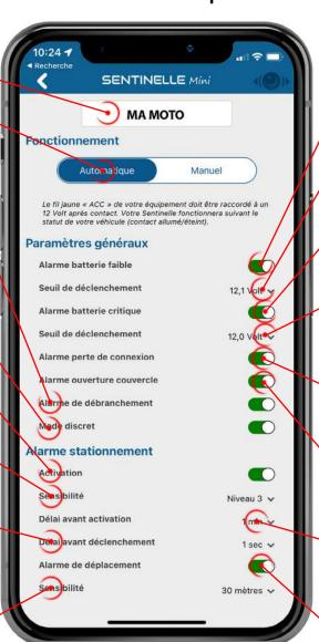
Activation / désactivation de l'envoi de la notification «batterie faible». Cette alarme est déclenchée lorsque la tension de votre véhicule est inférieure au seuil de déclenchement réglé.
